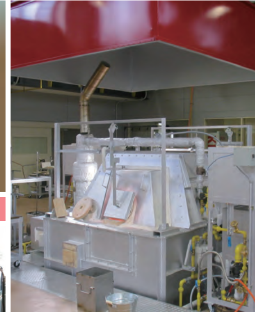
ガス式ガラス溶解炉
